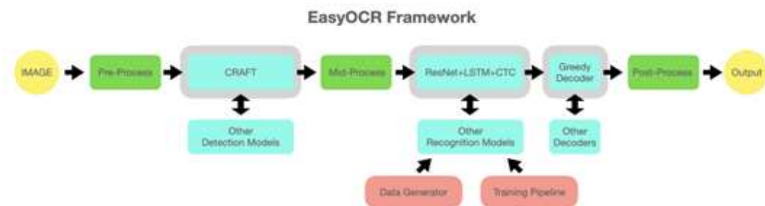
Рисунок 3 – Схема работы модели easyocr
