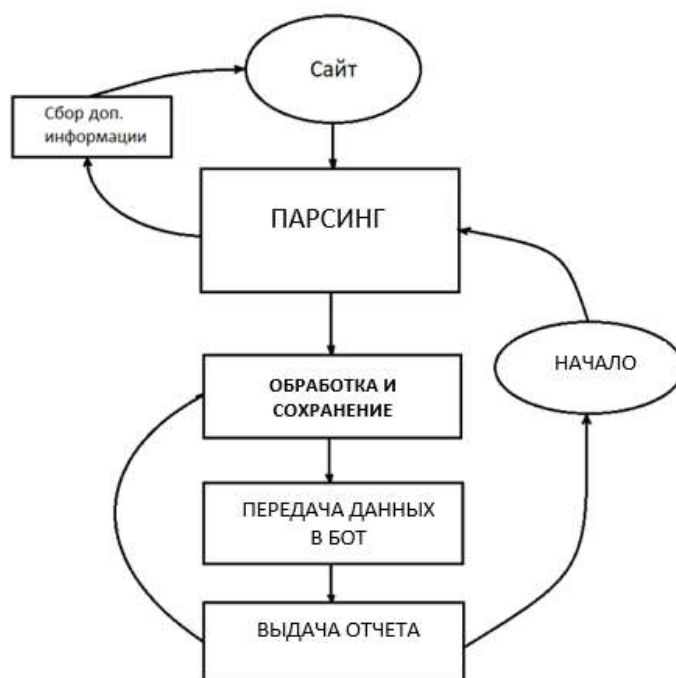
Рисунок 1 – Алгоритм работы сбора и обработки информации с сайта посредством Telegram- бота
