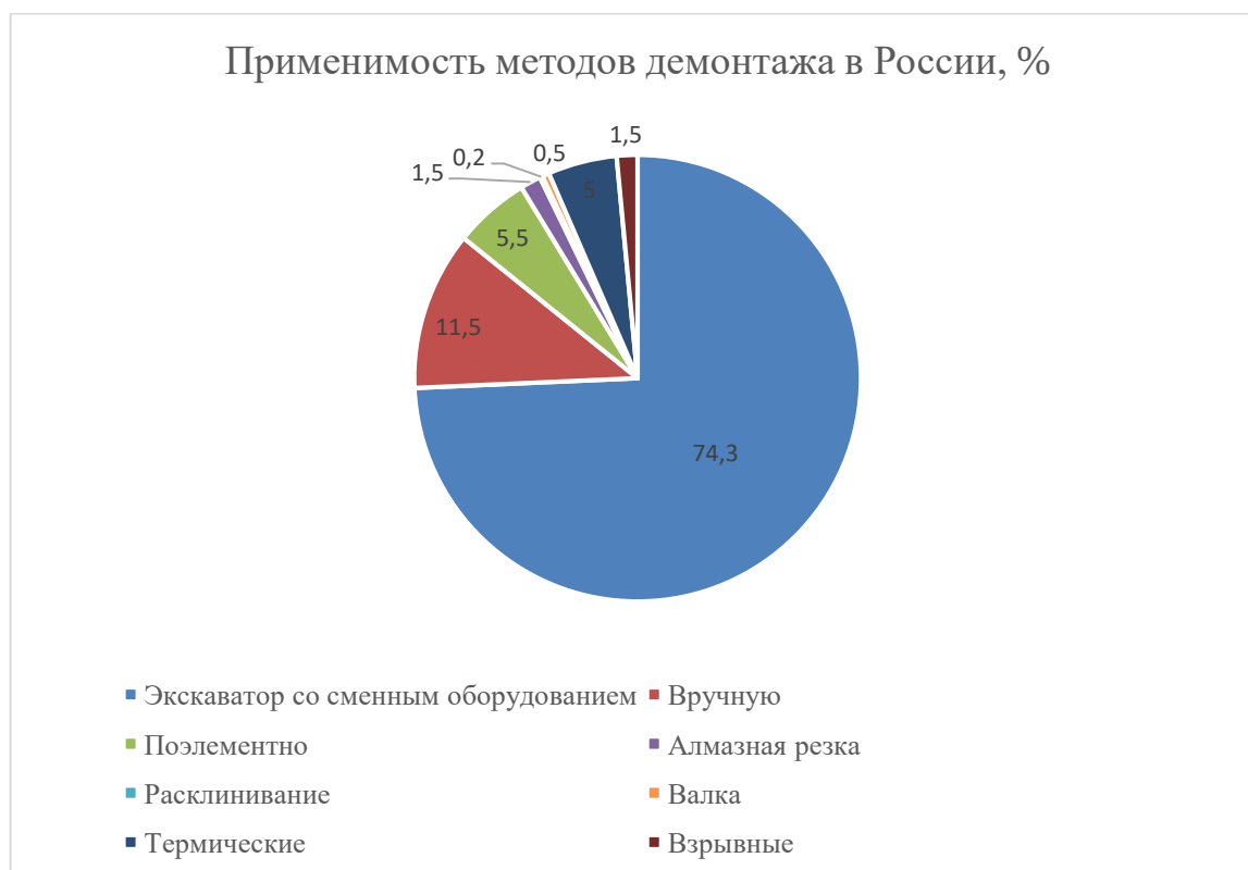
Рисунок 1 – Статистика применения технологий производства работ по демонтажу конструкций в отечественной практике
