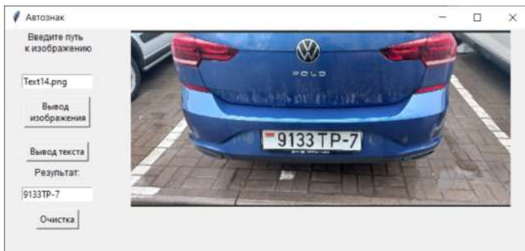
Рисунок 5. – Вывод изображения и текста номерного знака на экран
